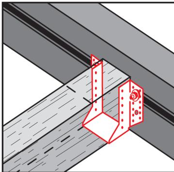
**Balkenschuhe kombi außen** werden aus 2,0 mm dickem feuerverzinktem Stahl hergestellt.
